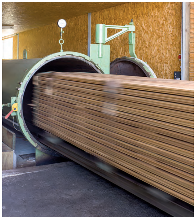
Autoclave destiné à l'imprégnation sous pression
